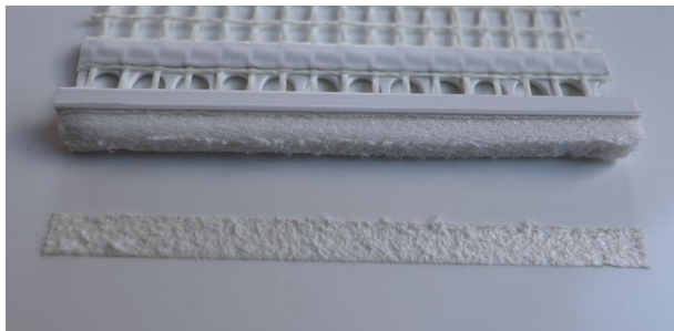
Abb. 1a) Beispiel für eine bestandene Klebprobe – Schaumbandrest auf der kompletten Klebefläche
