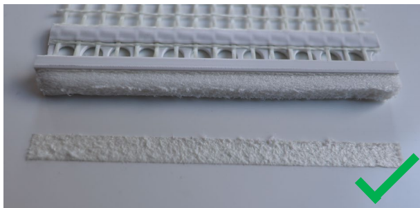
Abb. 1a) Beispiel für eine bestandene Klebeprobe – Schaumbandrest auf der kompletten Klebefläche
