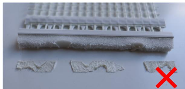
Abb. 1b) Beispiel für eine nicht bestandene Klebeprobe – lückenhafte Schaumbandreste auf der Klebefläche
